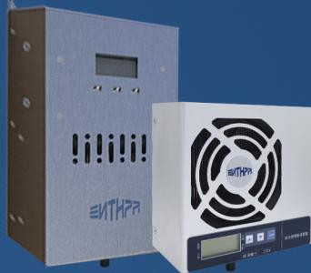
通过电子致冷方法在产品内部创造低于环境温度的冷端，并通过风扇迫使柜内相对湿热空气经过冷端从而在冷端不断产生凝露，持续收集冷凝水并排出电柜外，从而大大降低了电柜内湿气和水分含量。
